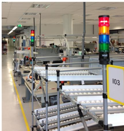
Die Information zur Nachversorgung wird mittels Sensor am Durchlaufregal erkannt und dem WIN-System mitgeteilt. Der Logistiker versorgt dann nach dem Pull-Prinzip den Mitarbeiter mit dem angeforderten Material. Mit dieser Systematik kann das First-in-First-out-Prinzip eingehalten werden.
