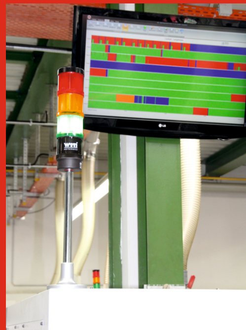
Il software visualizza gli stati delle torrette di segnalazione collegate alla rete
