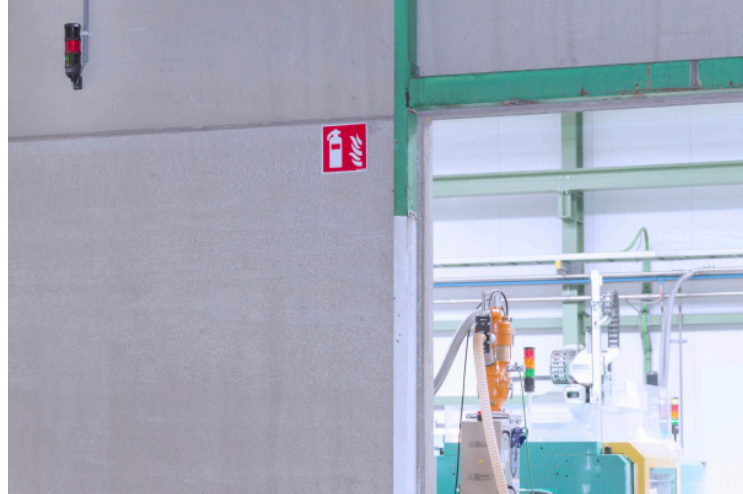
Bild links: Eine zusätzliche Signalleuchte in der Kantine zeigt an, ob und wenn ja in welchem Bereich der Produktionshallen eine Maschinenstörung vorliegt (Head-of-Line-Funktion).
