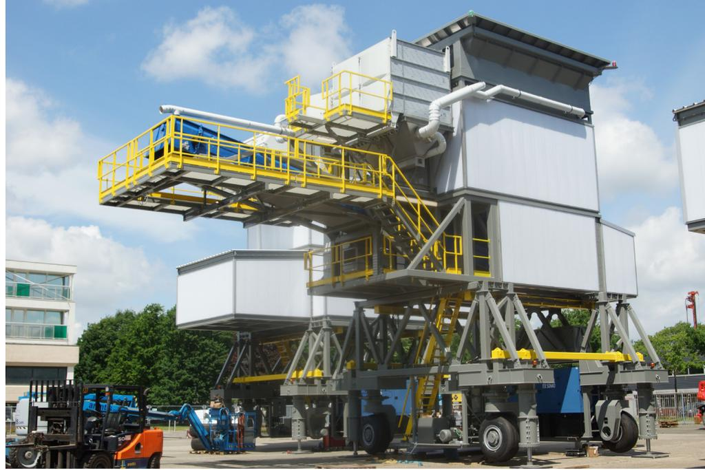
Mobile Waagen: Meyland baut jeden Trichter zunächst in Belgien auf, testet diesen und versendet ihn dann erst in das jeweilige Bestimmungsland.
