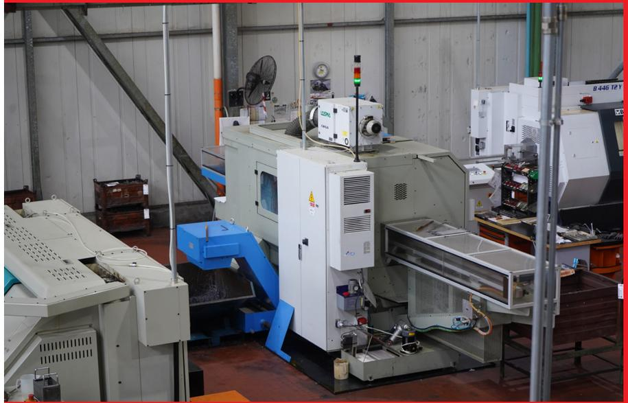
En la fábrica de BETA en Castiglione d'Adda se ha instalado en casi cada máquina una columna de señalización WERMA que incluye un módulo SmartMONITOR. Este se integra de forma muy sencilla (enchufar, conectar y usar) como elemento adicional en la columna de señalización de WERMA ya existente, y supervisa los estados o los números de piezas de las máquinas y las instalaciones.
