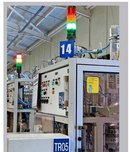
Bei SmartMONITOR ist es egal, welche Art von Maschine, welchen Alters oder Herstellers, das MDE-System von WERMA braucht nur eine WERMA-Signalsäule als Schnittstelle.
