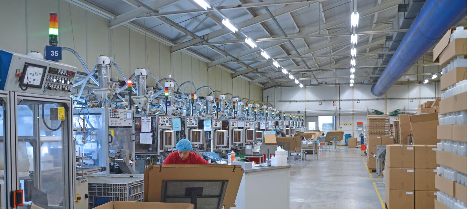
Bei Flestic sind mehr als 40 Maschinen mit SmartMONITOR ausgestattet. Seitdem ist sofort ersichtlich, welche Maschinen laufen, wo es zu Störungen oder einem Ausfall kommt und das Unternehmen kann ohne Zeitverzögerung reagieren.
