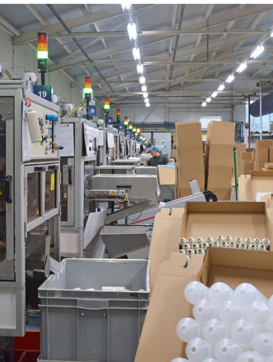
Mit Hilfe der dreistufigen Signalsäulen wird optisch der Status einer jeden Maschine angezeigt: Das rote Licht zeigt an, dass die Maschine steht, gelb leuchtet auf, wenn der Temperaturunterschied zu groß ist und grün signalisiert einen reibungslosen Ablauf.
