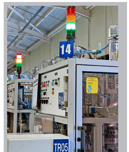
Indipendentemente dal tipo di macchina, dall'età o dal produttore, il sistema MDE di WERMA richiede un'unica torretta di segnalazione WERMA come interfaccia. interfaz.
