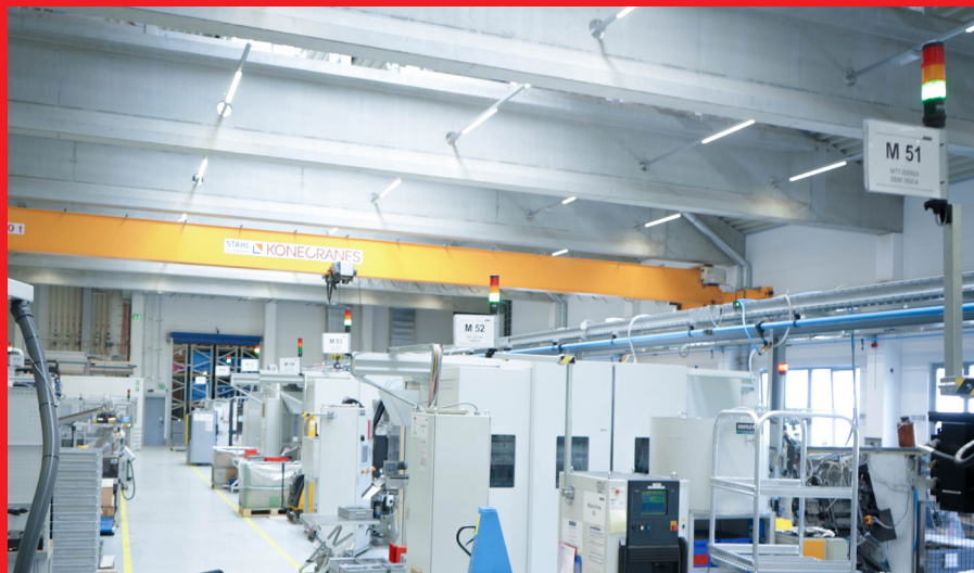
Bei SmartMONITOR entsteht durch die intelligente Vernetzung von Signalsäulen eine einfache, kostengünstige und nachrüstbare Alternative zu herkömmlichen komplexen MDE-Systemen.
