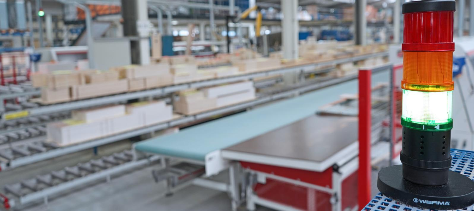
Chez HYMER, plus de 30 feux de signalisation de CO2 sont installés dans les halls de production et les différentes zones de production (ici par exemple, l'usinage du bois et le pré-montage des parois latérales) et contribuent ainsi à la bonne ventilation des locaux fermés.
