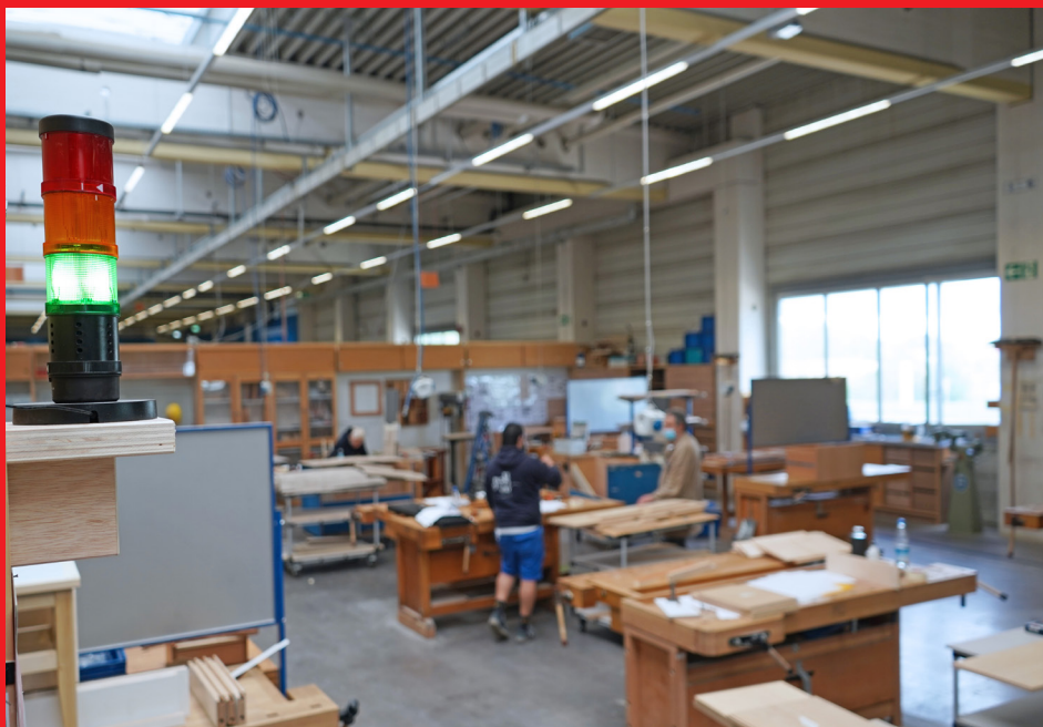
Anche nel laboratorio di formazione è installato un semaforo CO2. Se si accende il segnale verde, la concentrazione di CO2 è inferiore a 1.000 ppm, quindi l'aria ambiente rientra nei parametri.
